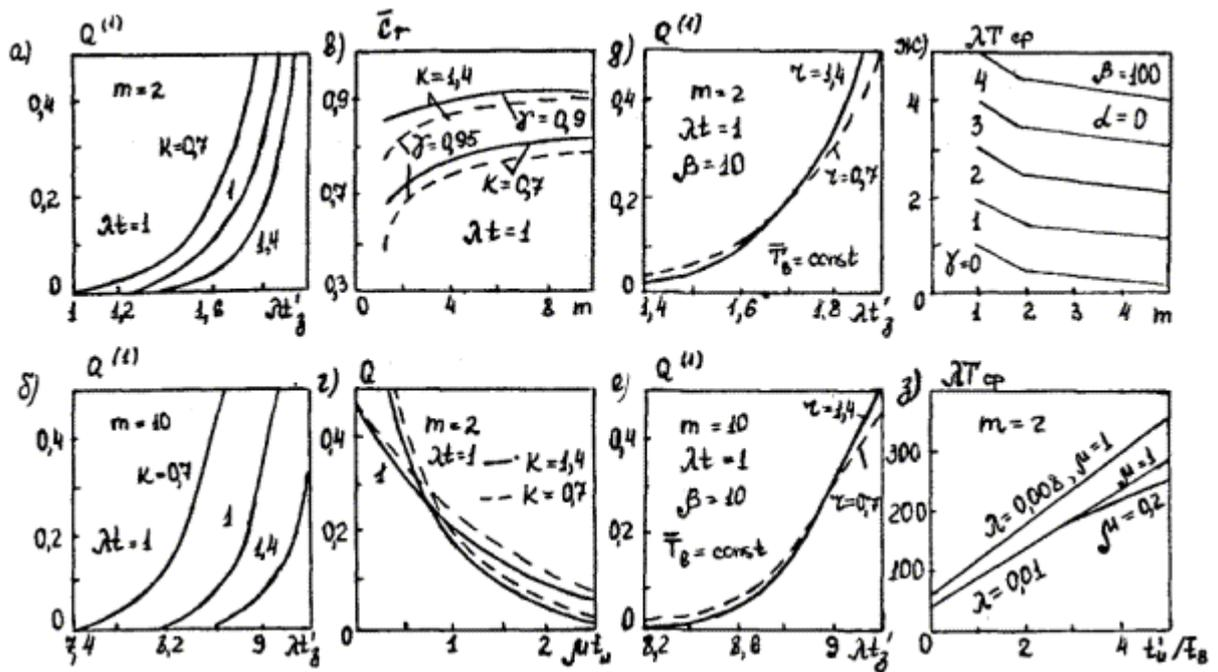
Рис. 11. Характеристики надёжности многоканальных систем при неэкспоненциальных распределениях наработки и времени восстановления
