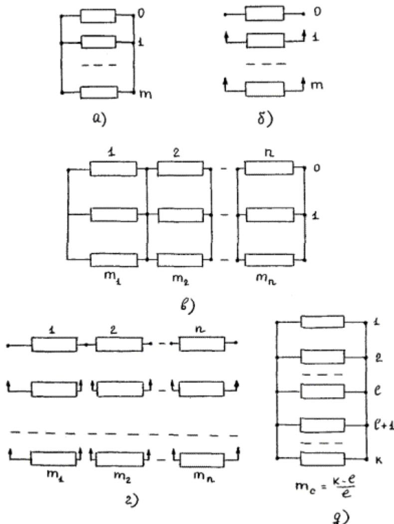
Рис. 1. Надежностно-функциональные схемы структурного резервирования кратности  $m_c$ .
