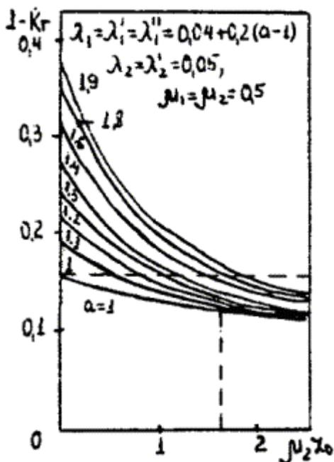
Рис. 16. Двухфазная система с зависимостью  $\lambda_1 = f(c_1)$
