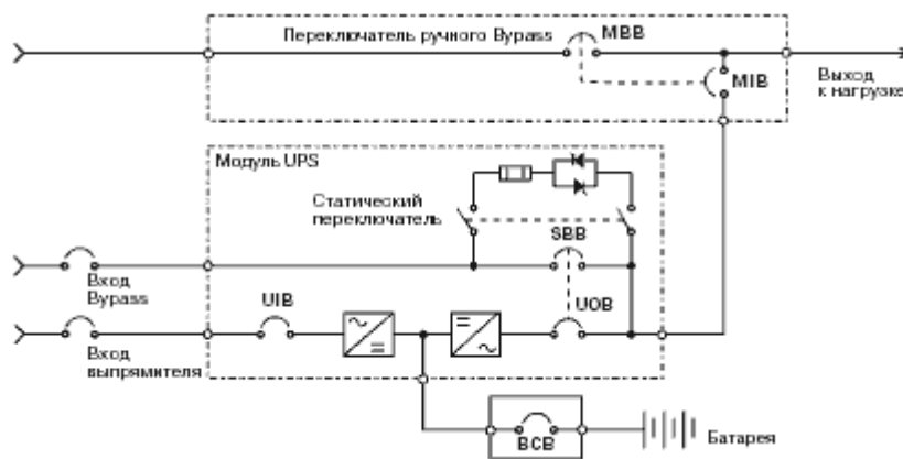
Рис. 1. Одномодульный UPS
